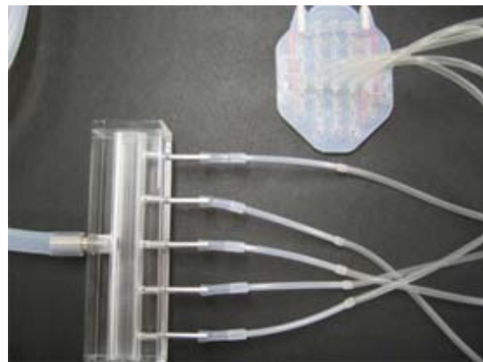
<図2. 74極電極の吸引システム>
