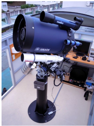
図 6 東天体観測室 Meade LX850-35F8ACF(主鏡筒の上にスターロック、白の 8cm サブ望遠鏡、反対側に 4cm 太陽望遠鏡を同架)
