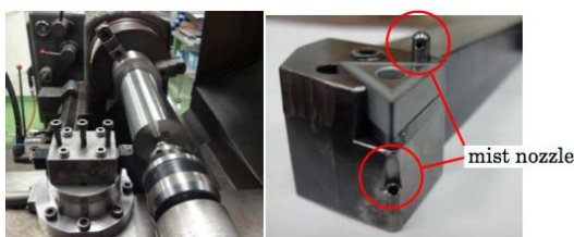
図2 CO 2 ミスト潤滑外周旋削実験装置の外観
