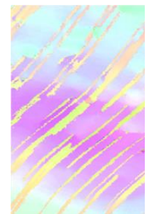
図5-7 Al/AlAg 2 合金のミルフィーユ構造組織に変形を加えて出現したキंक構造
