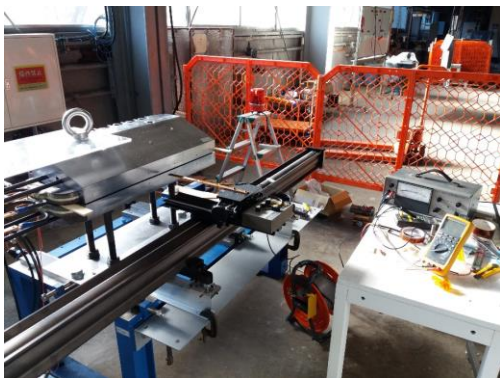
プロトタイプ偏向磁石と測定ベンチ
