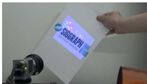
図2: 運動する平面の動きに応じて、紙面に印刷された図形と相互作用する映像コンテンツのプロジェクションマッピング
