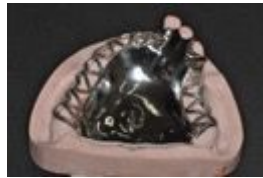
図 19 CAD による設計を行い、積層造形により完成 図 20 義歯床レジン部は CAD によりデータ化し、PMMA ディスクからミリング加工
