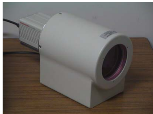
図5：大口径電子打ち込みCCD (EBCCD) システムの構造
