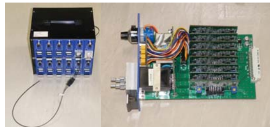
図6 多チャンネル型計測システムの外観(左)と計測モジュール(右)
