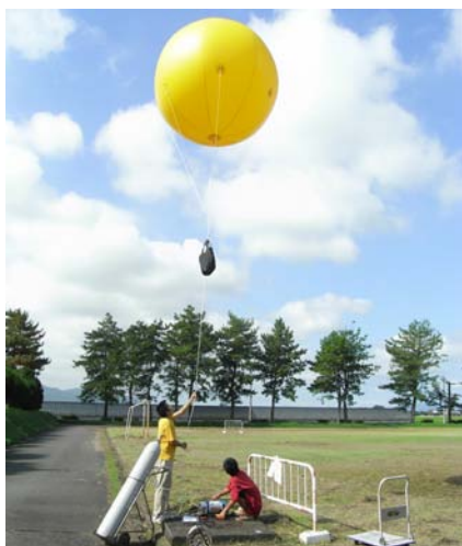
写真-2 係留気球による観測の様子
