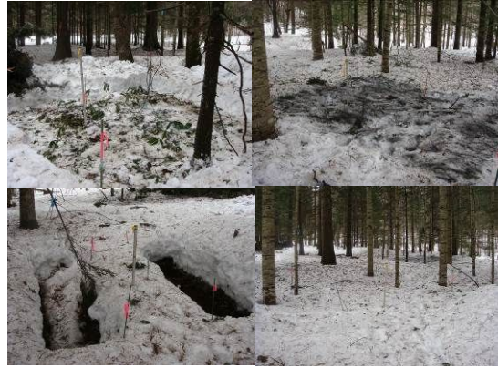
図4 林内実証試験での積雪制御処理。除雪区（左上）融雪剤散布区（右上）、凹凸区（左下）、対照区（右下）
