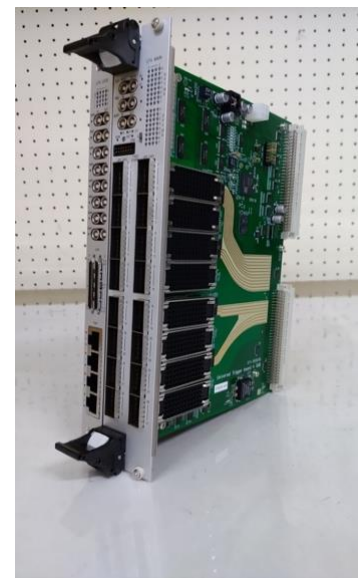
図 14: Belle II 用に開発した汎用ドリナーがボード UT4。
