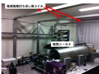
図10. 実験室内の環境磁場変動打ち消しコイルの概略図(左)と設置したコイルの写真(右)
