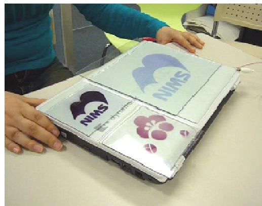
図 4-15 一次元直鎖状メタロ超分子ポリマーを用いたエレクトロクロミック素子。
