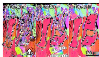
図 6A01b-9. 固相変態による [0001] 配向粒成長過程のその場観察結果。
