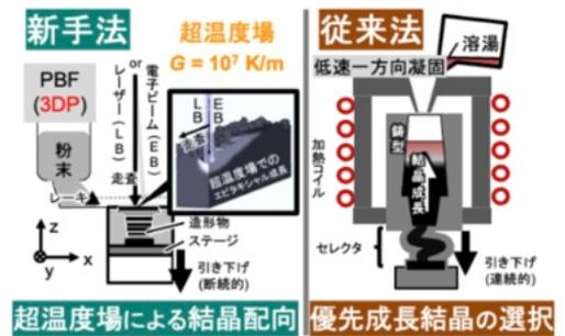
図 4-1. (a) 粉末床熔融結合(PBF)型金属 3D プリント(3DP)による単結晶育成。  $10^7$  K/m 程度(従来の単結晶育成では  $10^5$  K/m)の超温度場下での結晶成長では、瞬間的だが 1 m/s 程度の高速結晶成長を繰り返すため偏析がない結晶育成が可能である。
