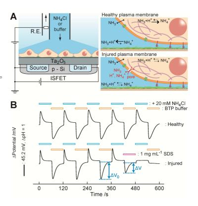
図. 細胞/ISFET 測定系。(A) ゲート絶縁膜上に培養した細胞近傍の緩衝液を、NH4Cl を含む緩衝液に瞬時に交換すると、NH3 の細胞膜受動拡散とアンモニア平衡反応により、過渡的に細胞外 pH が変動する。界面活性剤により細胞膜に空孔が形成されると、NH4+と H+も同時に細胞膜を拡散するため、過渡的な細胞外 pH 変動が減衰する。(B) NH4Cl 含有・非含有溶液の交換にともなう細胞/ゲート絶縁膜界面の経時的 pH 変動。細胞に界面活性剤 SDS を作用させると、溶液交換時の過渡
