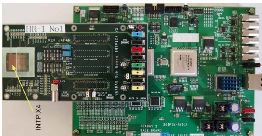
図 28. (左)ウエハーへの X 線自動照射装置。(右)SOI 検出器読み出しボード SEABAS2(SOI Evaluation Board with SiTCP)と INTPIX4 センサ・サブボード。
