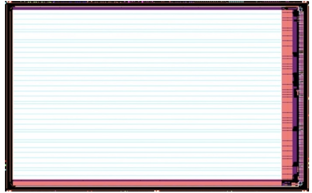
図 5. これまでで最大の面積を持つイベント駆動型 X 線ピクセル検出器 XRPIX7. 36 \mu\text{m} 角ピクセル、23.3 万画素(15.3 x 24.6mm 2 角)。
