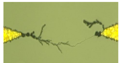
図9. 電解重合による導電性分子の自己組織的ネットワーク形成。
