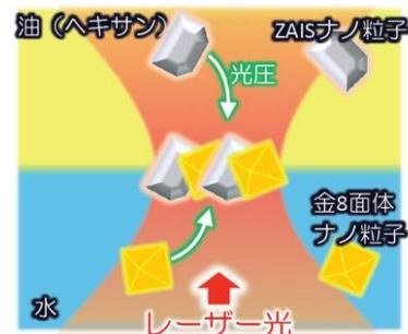
図 2-4 油水界面における ZAIS 量子ドット (油層) と金正八面体ナノ結晶 (水層) の同時捕捉。上図: 捕捉された量子ドット・金正八面体ナノ結晶の集合体の顕微散乱画像。下図: これらの概念図。
