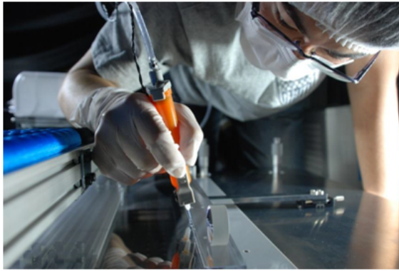
図 10: 石英輻射体と焦点鏡の接着の様子 (左)、及び 18ch の測定時間分布 (右)。黒が実測データ、赤がシミュレーション結果を示す。
