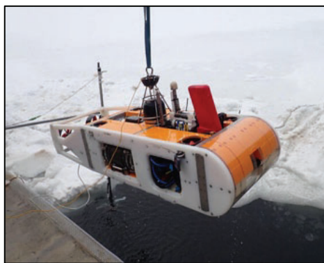
図 2 完成した AUV の氷海試験
