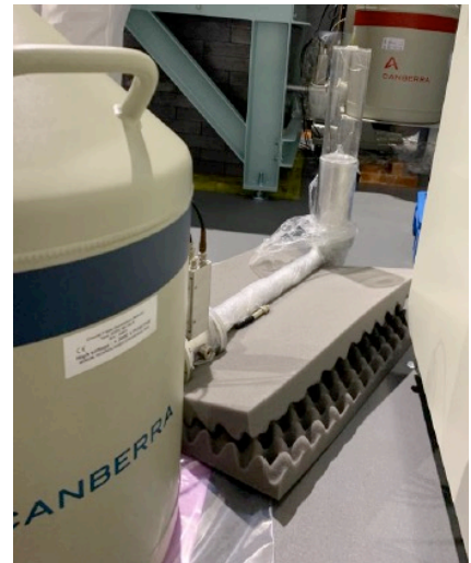
図 D01 で製作したゲルマニウム検出器
