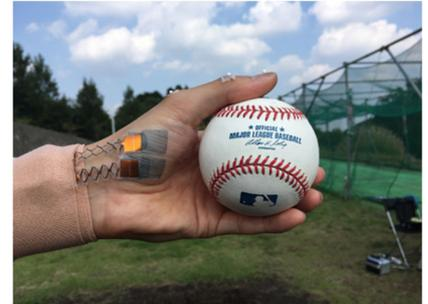
図 7: アスリート用ウェアラブル筋電計測デバイス
