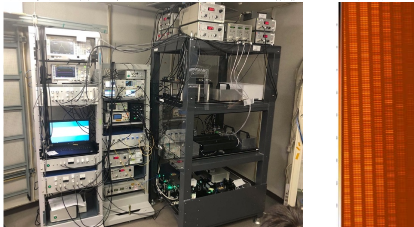
図 1 岡山に設置された光コムシステム（左）。スペクトルの一部（波長 450~500 nm：右）
