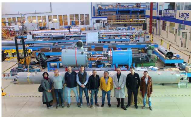
図 5 完成した 7m の D1 磁石実証機, CERN 搬入時の写真
