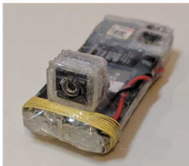
図 2 : 開発したセンサデータロガー。新潟に生息するオオミズナギドリに装着された。
