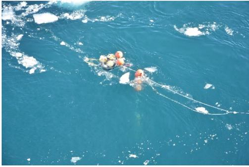
図5 開発した氷海プロファイラーブイの回収
