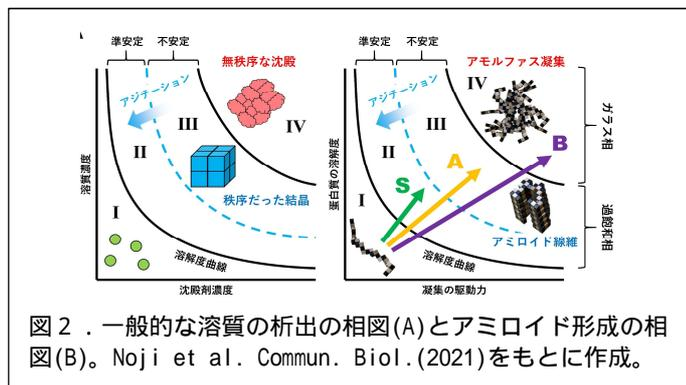
図2. 一般的な溶質の析出の相図(A)とアミロイド形成の相図(B). Noji et al. Commun. Biol. (2021)をもとに作成。
