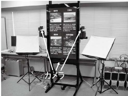
図1 視線計測・情報提示システム
