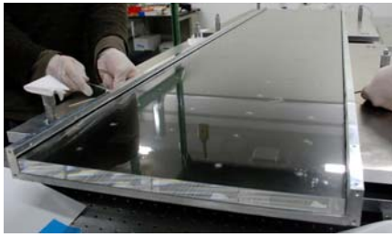
図9：作成中の石英輻射体と焦点鏡。石英板2枚と焦点鏡が接着されている。
