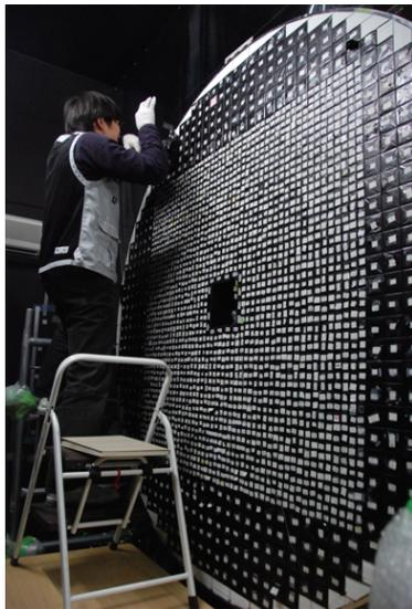
図 2: KOTO 実験の CsI 電磁カロリメータ。
