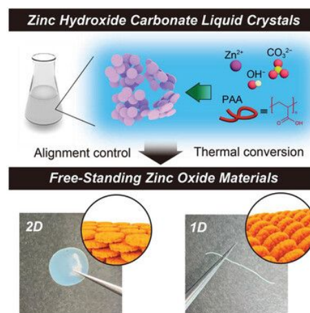
図3. 水酸化炭酸亜鉛コロイド液晶を前駆体とする自立性酸化亜鉛材料の開発。
