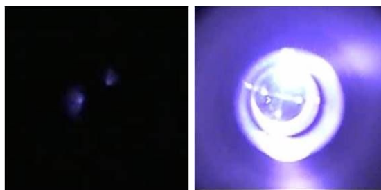
図4 超臨界アルゴン中の放電写真 (5 MPa, 290 K, 160 pps)
