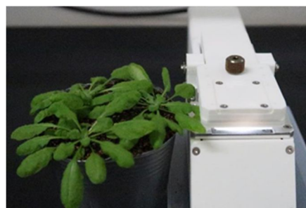
図2. ポータブル気孔撮影装置
