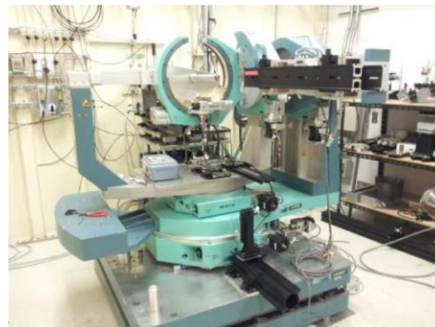
図 5 SPring-8 の X 線を用いた超微細粒銅の塑性変形中のその場転位密度測定装置
