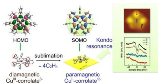
図2 bicyclo[2.2.2]-octadiene (BCOD) fused copper corrole (Cu-BCOD)の真空蒸着により Cu-Benzo Corrole への変化。金表面での STM 像と、スピンの存在を示す Kondo 共鳴ピーク
