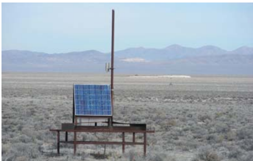
地表検出器アレイ。後方に1.2km間隔でさらに4台が見える
