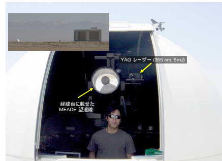
図6 ライダー装置は、望遠鏡格納庫から100m離れた地点の天文ドーム中に設置した。大気分子及び浮遊する微粒子で散乱されたYAGレーザーからのパルス光を、経時的(=空間的)に記録して、大気透明度をモニターする。観測開始前と終了後に1000発を垂直および水平に射出している。
