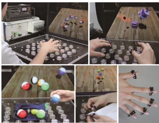
図 1: 開発した 3 次元 6 自由度モーションセンサシステムによる計測例
