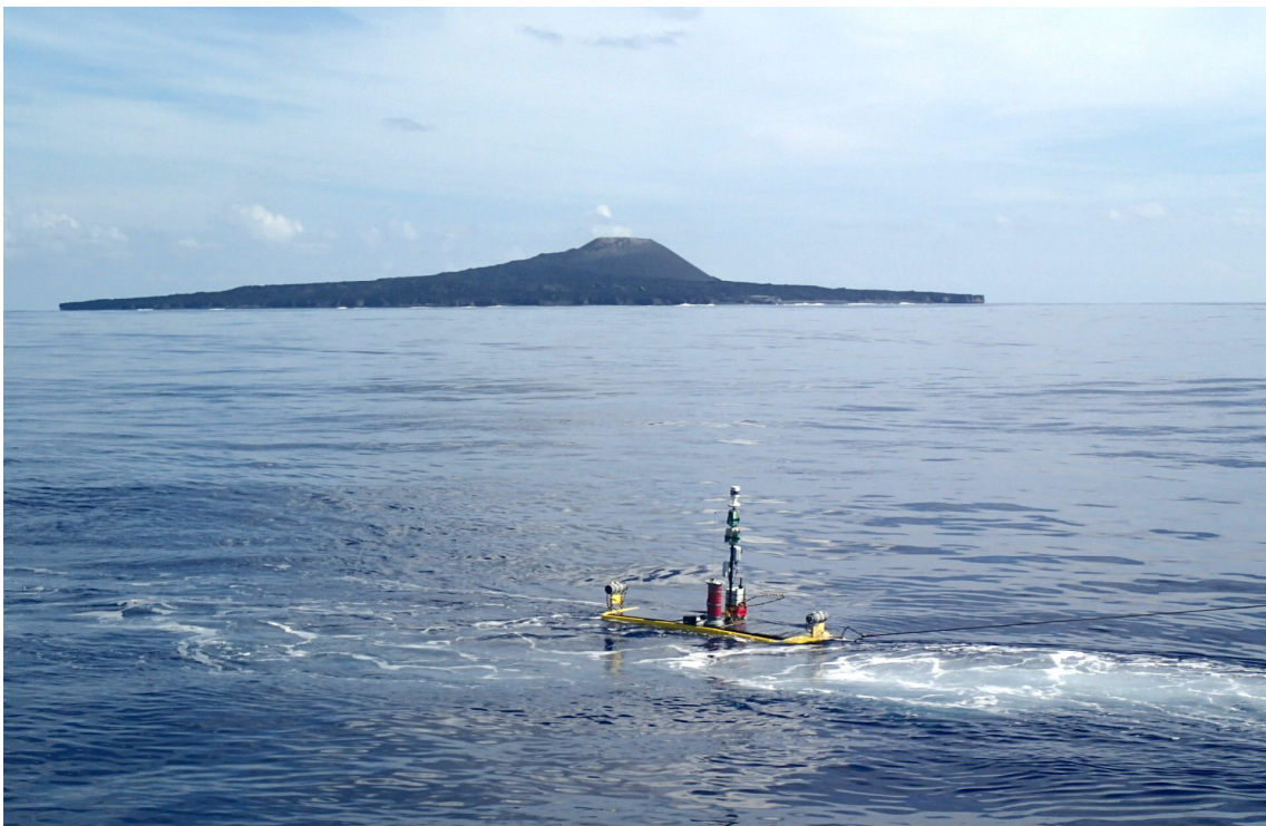
図3：西之島近海を周回観測中の離島火山活動リモートモニタリングシステム
