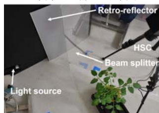
図2 AIRRによる照明光の収束を用いた生育中のトマトの葉に囲まれた領域の分光イメージング実験配置。
