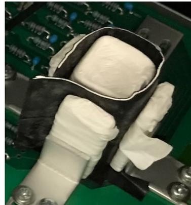
CsI(Tl)とのコインシデンスを取ると、さらにノイズが低減され、1.5keV 相当のエネルギーデポジットも読み出せる事も実験から実証できた。そこで我々は次にプラスチックシンチレーターと CsI(Tl)シンチレーターを 2 層に積層し、その全てに MPPC を取り付けられた非常に小型のミニコンプトンカメラを製作した。これが次のページの写真に示されている。写真には 1 層目だけが写っており、中心の白いテフロンテープで巻かれた 4 つのシンチレーターが 1cm キューブのプラスチックシンチレーターである。またその周り 8 個が 1cm キューブの CsI(Tl)シンチレーターである。各々下側には MPPC が取り付けられている。そして MPPC の信号は、基盤に取り付けられた抵抗やコンデンサを介して、後段の回路に導かれる。また写真には写っていないが、2 層目は、4 つの CsI(Tl)が取り付けられており、1 層目のプラスチックシンチレーターの直ぐ下に設置されている。この回路基板は、通常の基板に比べ 8 倍薄く、数 10keV のガンマ線であれば、ほぼ 100%透過する。
