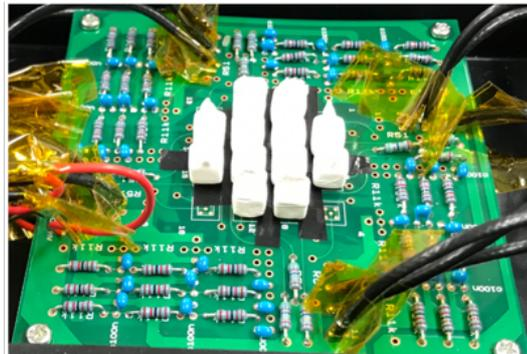
以上の実験から、2種類のシンチレーターをMPPCに取り付けて積層し、マイナス20度に冷やして動作させれば、コンプトンカメラとして働く事が分かった。しかし、MPPCはまだ宇宙空間で安定に動作した実績がない。
