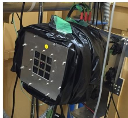
GAGG(Ce)シンチレーターが囲んでいる写真である。さらにこのシンチレーターにマルチアノード光電子増倍管やアパランシフォトダイオードを取り付け、読み出し回路と一緒に筐体に収めた写真が右に示されている。またこの検出器に偏光ビームを照射し、その性能を調べたものが次のページのグラフである。横軸がガンマ線の散
