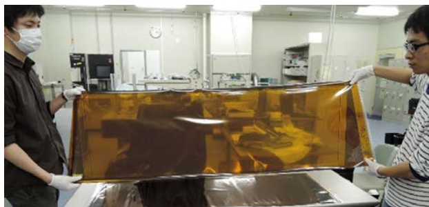
図3 : 試作したマイクロメガス用高抵抗陽極フォイル
