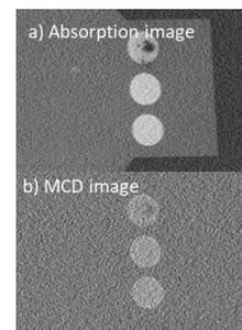
図2 全電子収量法により計測したCo L<sub>3</sub>吸収端の(a)吸収像と(b)MCD像。
