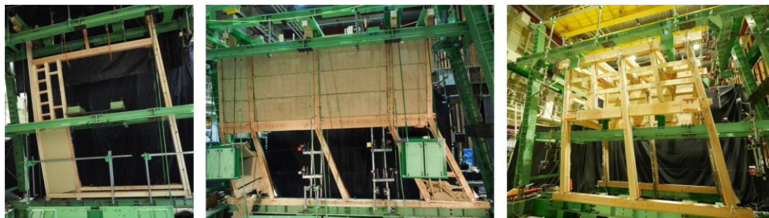
(a)補強京町家試験体
