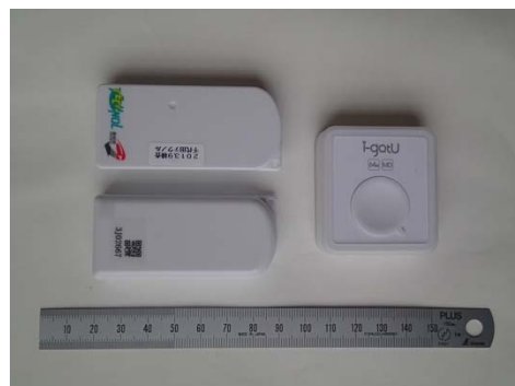
図1 個人被ばく線量調査で使用した線量計 (D-シャトル：左) とGPS ロガー (右)
