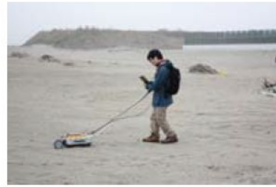
(a) 地中レーダの探査風景
