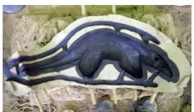
中型原型では、難易度を高めるために狛犬の形状を用いた。両前脚での踏ん張りと折り曲げた後ろ脚との内側の型は簡単な大寄せでは取れないため記録のためにあえて実施した。製作した 鋳型は、阿像2体、吽像1体の計3体であり、1体は外部の鋳造工房で実施し技法の違いを確認した。
