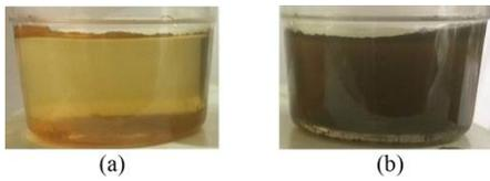
図 5 鉄電解とグロー放電電解の併用による粒子合成時（放電電流 5 mA, 15 分後）の溶液の写真．初期溶存酸素濃度は(a)8.77 mg/L, (b)2.03 mg/Lとした．(a)ではヘマタイトが, (b)ではマグネタイトが合成されている．
