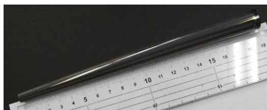
図11 楕円筒状石英ガラスに成膜した NiC/Ti多層膜スー パーミラー ( m=2 、長さ190mm、表面粗さ1nm) さらに、スーパーミラーを離形した後、形状
